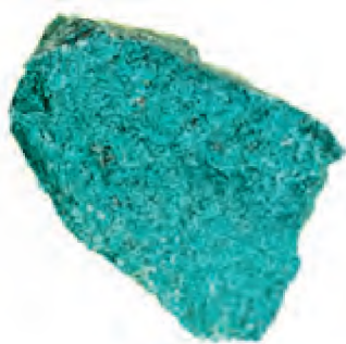
Ryc. 11. Węglan miedzi zidentyfikowany w warstwie wierzchniej siekierki
