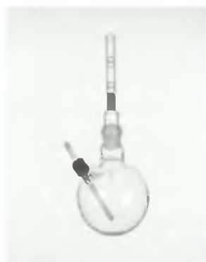
Rysunek 1. Oscylator gazowy Flammersfelda
